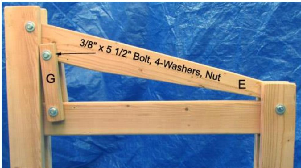
13. Soulevez la partie G et connectez-la à la poignée E à l'aide d'un boulon de 3/8" (10 mm) x 5 1/2", de 4 rondelles et d'un écrou.
