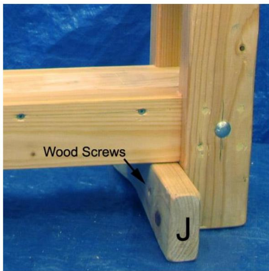
15. Befestigen Sie J mit 2 1/2-Zoll-Holzschrauben oder 3-Zoll-Nägeln
