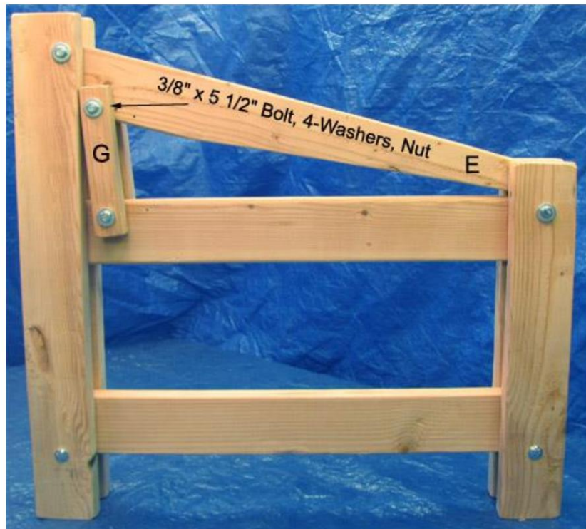
11. قسمت G را بلند کرده و با استفاده از پیچ 3/8 اینچی (10 میلی متر) 5 1/2 x اینچ (140 میلی متر) و 4 واشر به دسته E وصل کنید. و یک مهره
