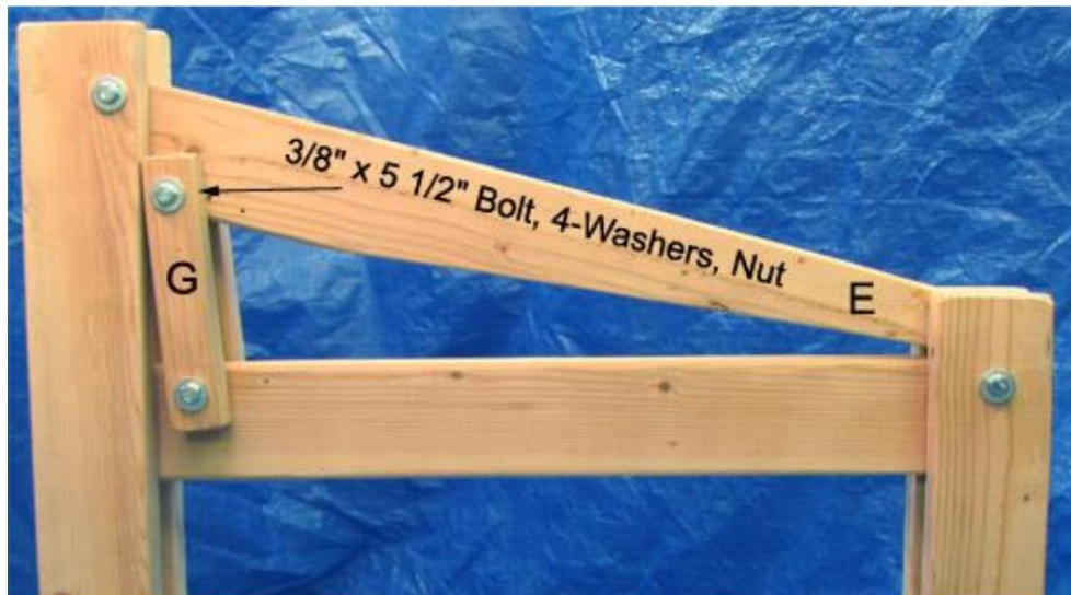
13. قسمت G را بلند کرده و با استفاده از پیچ 3/8 اینچ (10 میلی متر) 5 1/2 اینچ، 4 واشر و یک مهره به دسته E وصل کنید.
