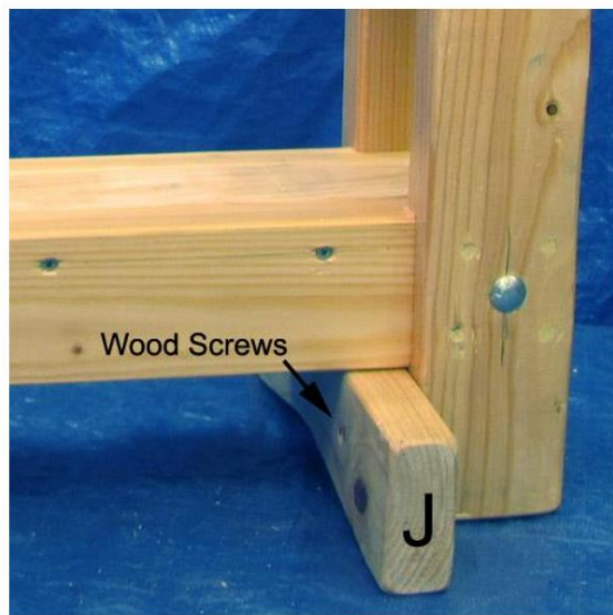
15. J را با استفاده از پیچ های چوبی 2 1/2 اینچی یا میخ های 3 اینچی وصل کنید
